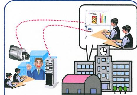
IPv6の任意の端末への直接到達性の特徴と複数拠点への配信機能を活用し、教材コンテンツの配信や、遠隔授業等の教育ネットワークシステムを構築。
