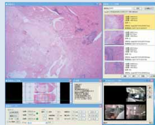
図4.テレパソロジーシステムの診断画面 遠隔の顕微鏡からの映像が表示され、観察位置を動かしながら診断を行う。TV会議により診断に関する情報や診断結果などのやり取りを行う。
