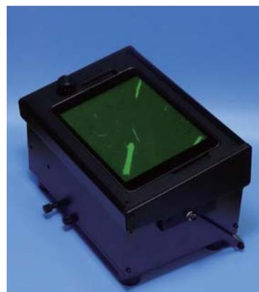
可搬型のアスベスト計測機器
